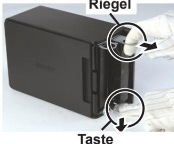
Drücken Sie auf die Entriegelung unterhalb der Festplatte und ziehen Sie die Schlaufe über dem Laufwerk 2 cm heraus.
