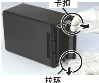
按住硬盘底下的“释放”并将硬盘上的选项卡拉出 2 厘米（约 1 英寸）。
