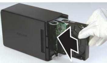
Insérez le nouveau disque jusqu'à ce qu'il se mette en place.
