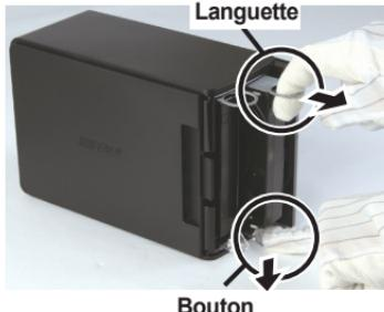
Appuyez sur la molette de déclenchement située en dessous du disque, et tirez la languette placée au-dessus du disque vers l'extérieur de 2 cm (environ 1 pouce).
