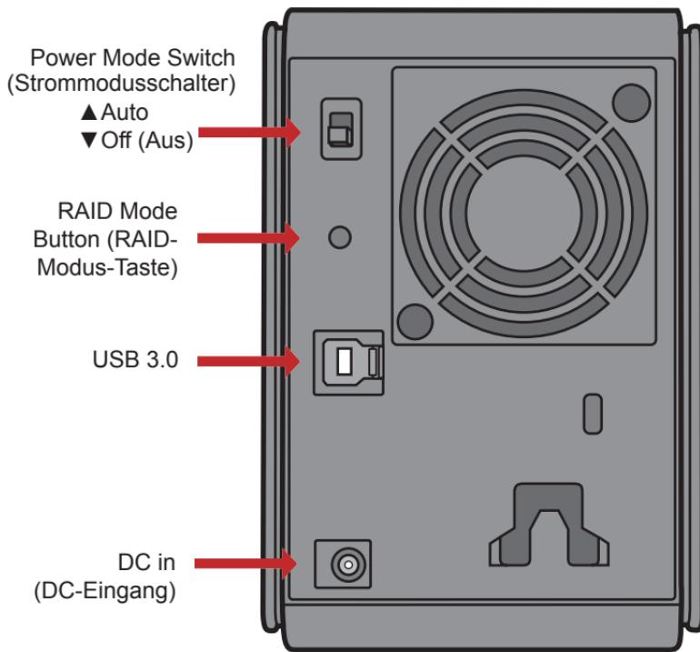
Hinweis: Zum Wechseln zwischen RAID-Modi können Sie entweder die RAID-Utility oder die RAID-Modus-Taste verwenden. Die RAID-Utility wird mit der Software auf der DriveNavigator-CD mitgeliefert. Weitere Informationen zur Verwendung der RAID-Modus-Taste erhalten Sie im Referenzhandbuch.
