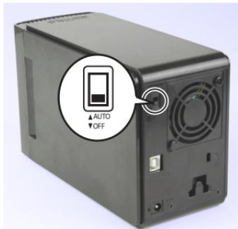
Apague la DriveStation y desconecte todos los cables.
