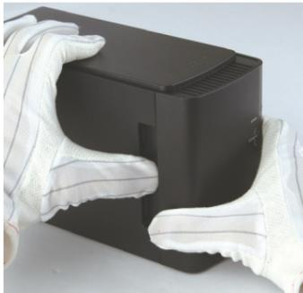
Tire de la cubierta frontal y presione a la vez sobre la cavidad del lateral izquierdo.
