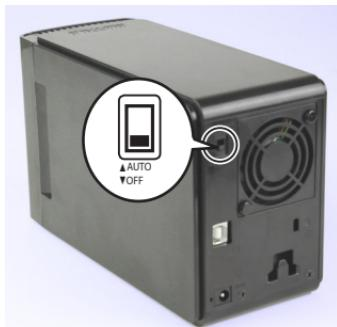
Fahren Sie die DriveStation herunter und trennen Sie alle Kabel.
